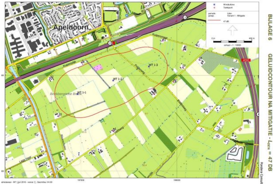
Kaartje 6 laat de rode lijn de contour zien van 47 dB nadat de windmolens in de 'stillere stand' zijn gezet tijdens de nacht, zodat aan de norm wordt voldaan.
